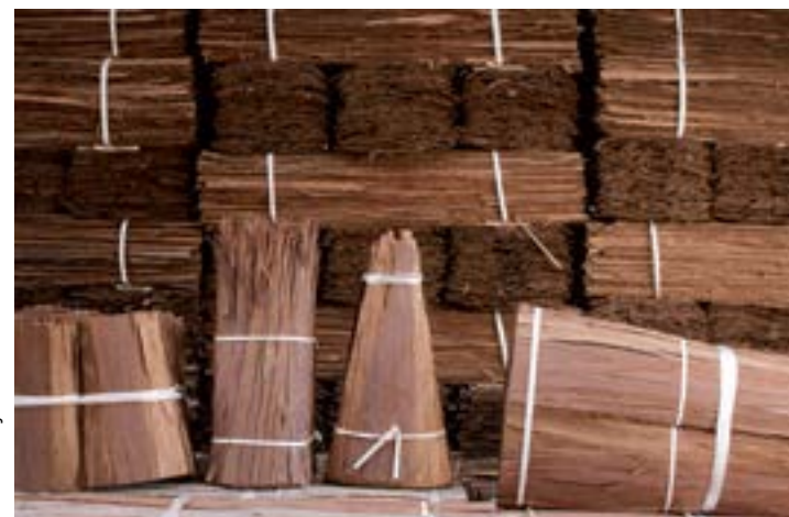
Et udpluk af de mange forskellige slags Hiwadabuki-tagspån, der bliver brugt til tagdækningen. Foto: Corey Fuller
