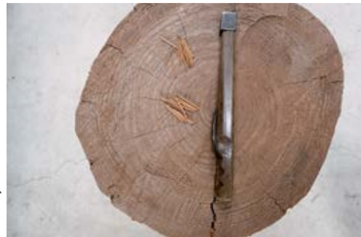
Den særprægede tækkehammer og to forskellige slags bambussøm, der bruges til tagdækningen. Foto: Corey Fuller
